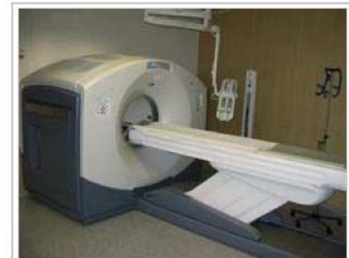
Bild eines PET/CT-Systems mit 16-Zeilen-CT; das deckenmontierte Gerät ist eine Hochdruckspritze für das CT-Kontrastmittel
