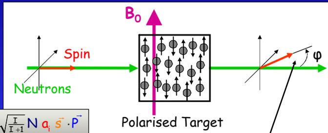
$$V_{\text{eff}}^{\text{s.d.}} = \frac{4\pi\hbar}{m} \sqrt{\frac{I}{I+1}} N a_i \vec{s} \cdot \vec{P}$$
